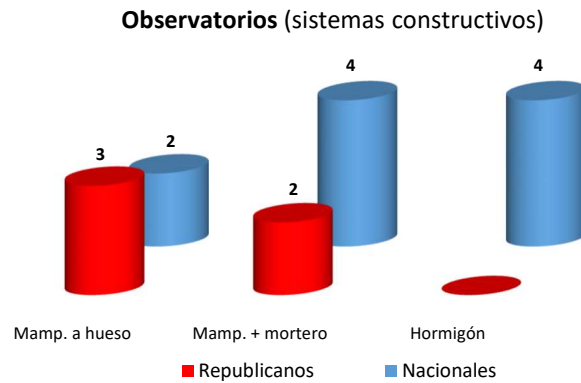
Figura 36. Distribución de los observatorios, en función de los sistemas constructivos empleados. (N.A.)- Falta un observatorio nacional (en caverna), que no se ha incluido en el gráfico.
